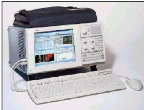
圖20：邏輯分析儀每秒3.4Gb擷取資料頻寬大於Rambus每秒1.6Gb資料傳輸需求
