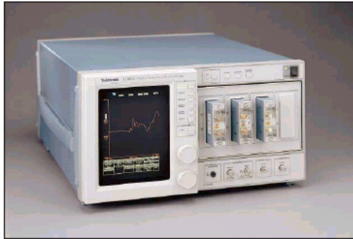
圖 5：實際的高解析度 TDR 設備
